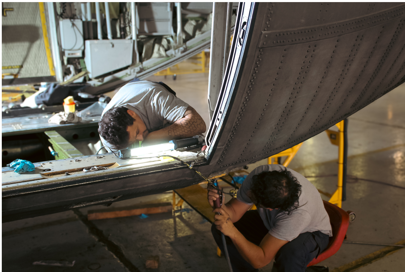
Reparación de grieta y cambio del sloping longeron
